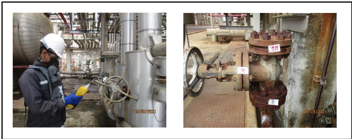
รูปที่ 1 ตัวอย่างอุปกรณ์และการตรวจวัดการรั่วซึมจากอุปกรณ์ในโรงงานที่เป็นแหล่งกำเนิดชนิดฟุ้งกระจาย
